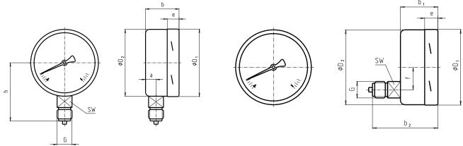
Dimensions in mm Models b2 D1 D2 G SW а b b1 h ± 1 е P1875 49,5 <sup>1)</sup> 49,5 <sup>1)</sup> 83 <sup>1)</sup> 15,5 159 50 118 G 1/2 B 17,5
